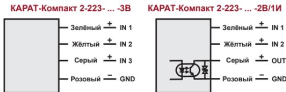
**Рисунок 5 – Принципиальная схема подключений импульсного входа/выхода**
