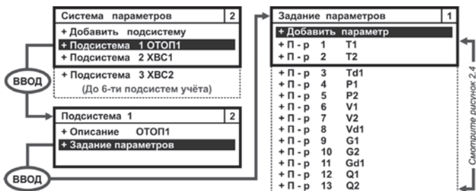
Рисунок 3.22 Пример развернутого изображения меню Система параметров
