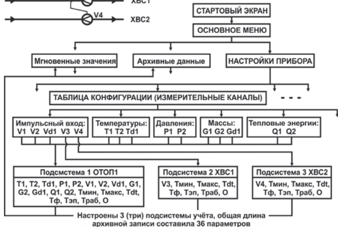
Рисунок 2.5 – Пример реализации алгоритма настройки вычислителя
