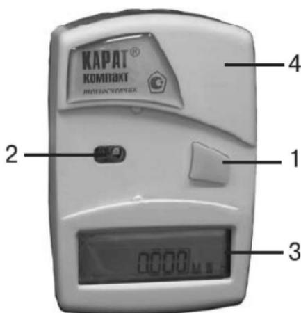
**Рисунок 6. Вид лицевой панели вычислителя теплосчётчика**
