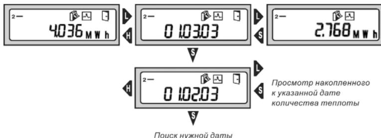
**Рисунок 16. Просмотр месячного архива теплосчётчика**
