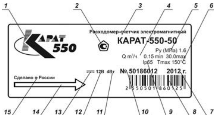
Рисунок 1.8 – Маркировочные обозначения на шильдике расходомера
