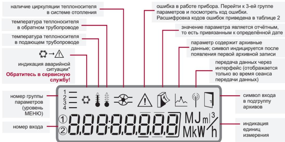
Рисунок 8 – Информационные поля на ЖКИ теплосчётчика
