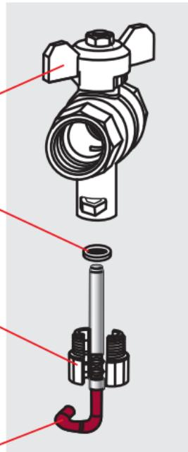
**Монтаж теплосчётчика в обратный
