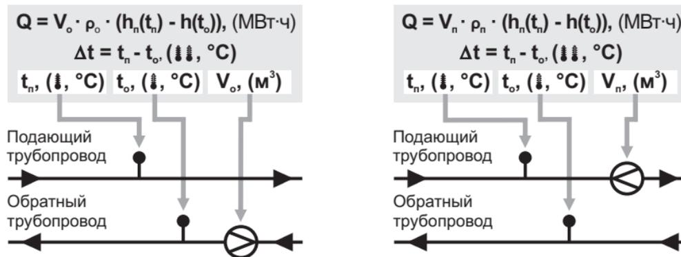
*Рисунок 3 – Алгоритмы вычисления тепловой энергии, реализованные в теплосчётчике*
