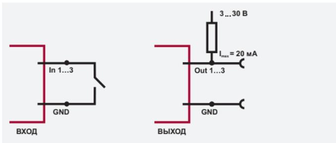
**Рисунок 6** – Подключение внешних устройств к импульсным входам/выходам
