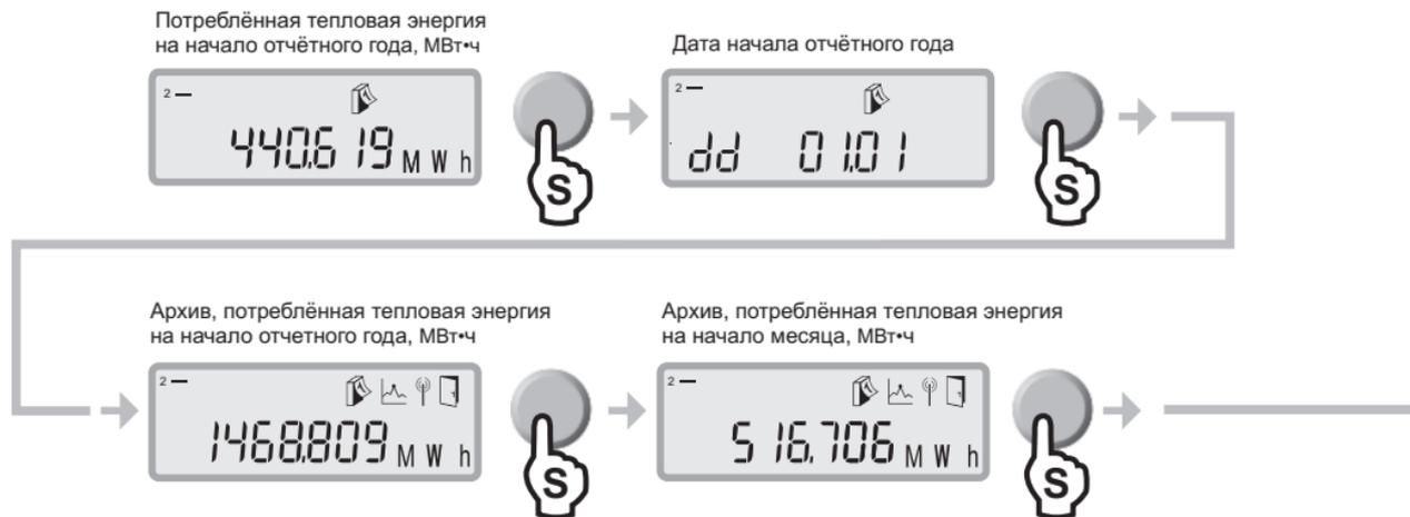
*Рисунок 12 – Последовательный переход между параметрами второй группы*
