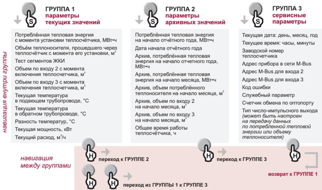
Рисунок 9 – Структура меню теплосчетчика
