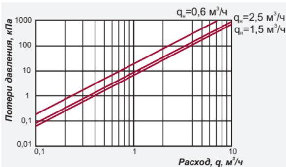
Рисунок 1 – Номограмма потери давления на теплосчётчиках
