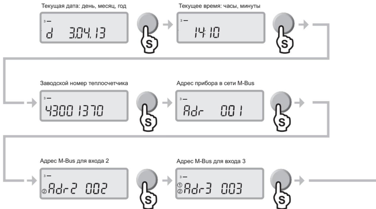
Рисунок 13 – Последовательный переход между параметрами третьей группы
