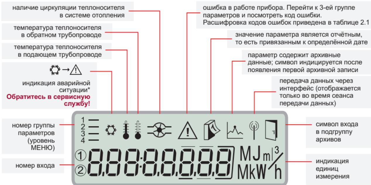
\* – теплосчетчик **продолжает вести вычисление потребленной тепловой энергии**, значение которой выводится на ЖКИ. **Вся остальная информация блокируется**. Прибор не реагирует на нажатие кнопки управления.
